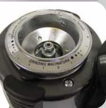
Ajuste molido: 0,021 mm. por salto Ground adjust: 0,021 mm. per step
